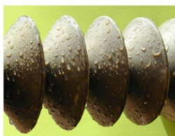
Фиг. 2.24 Хидрофобност на силиконов изолятор, експлоатиран на електропровод в течение на 15 г и имащ слой замърсяване.
