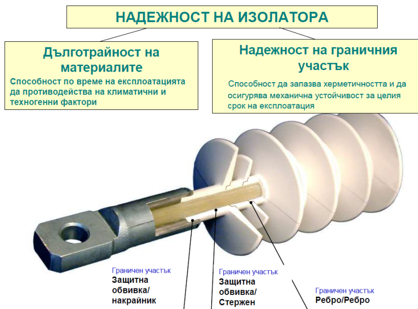
Фиг. 2.17 Полимерни изолатори последно поколение (течна гума)
