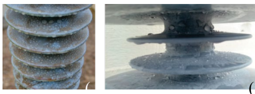
Фиг. 2.12 – остарели в експлоатация (a) и изкуствено замърсени (b) изолатори
